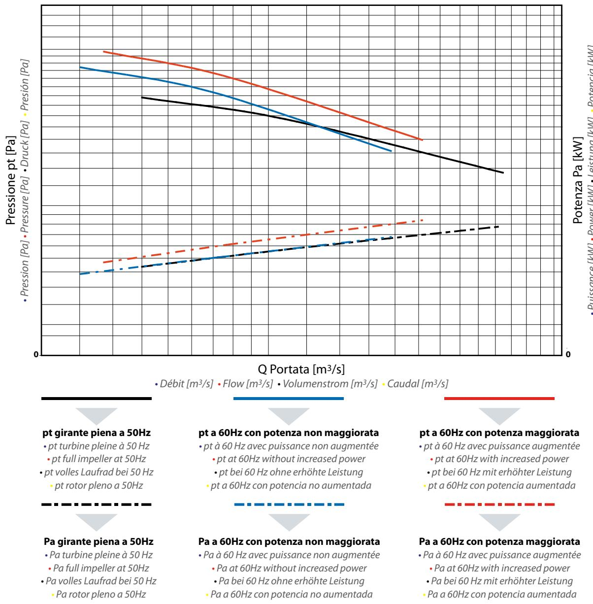
Un ventilatore con girante dimensionata considerando l'incremento di potenza a 60Hz ha una curva (**curva rossa**) che copre totalmente il campo di funzionamento del ventilatore standard a 50Hz (**curva nera**).
