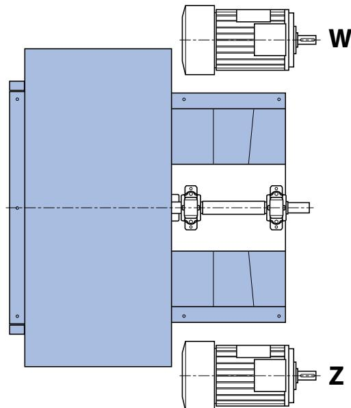
Posizionamento standard dei motori per ventilatori a trasmissione in funzione dell'orientamento.
