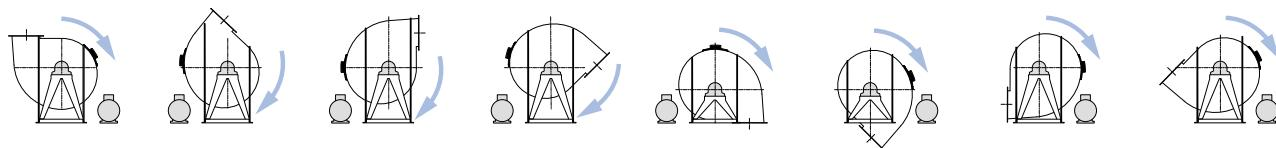
LG0 POS.Z LG45 POS.W LG90 POS.W LG135 POS.W LG180 POS.W LG225 POS.Z LG270 POS.Z LG315 POS.Z
